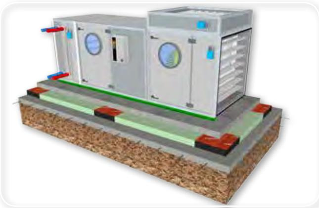
Installare l'unità trattamento aria sul basamento flottante come di consueto
